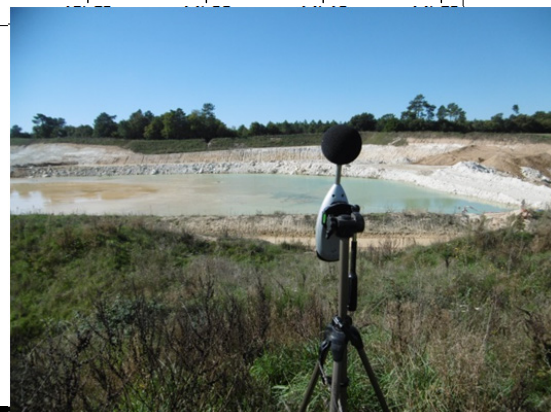
Appareillage : sonomètre SOLO 01dB de Classe 1 - Calibreur ACLAN CAL 01
