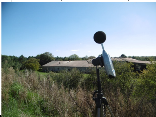
Appareillage : sonomètre SOLO 01dB de Classe 1 - Calibreur ACLAN CAL 01
